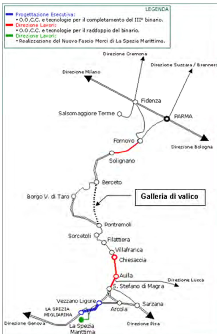
Figura 14 Interventi in atto e previsti sulla linea Pontremolese.
