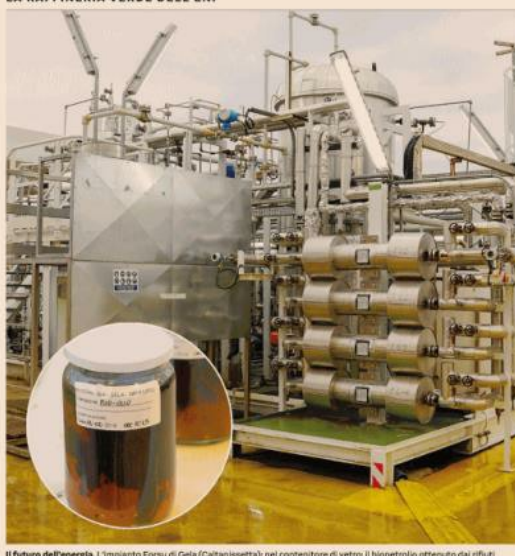
Il futuro dell'energia. L'impianto Forsu di Gela (Caltanissetta), nel contenitore di vetro il biopetrolio ottenuto dai rifiuti
