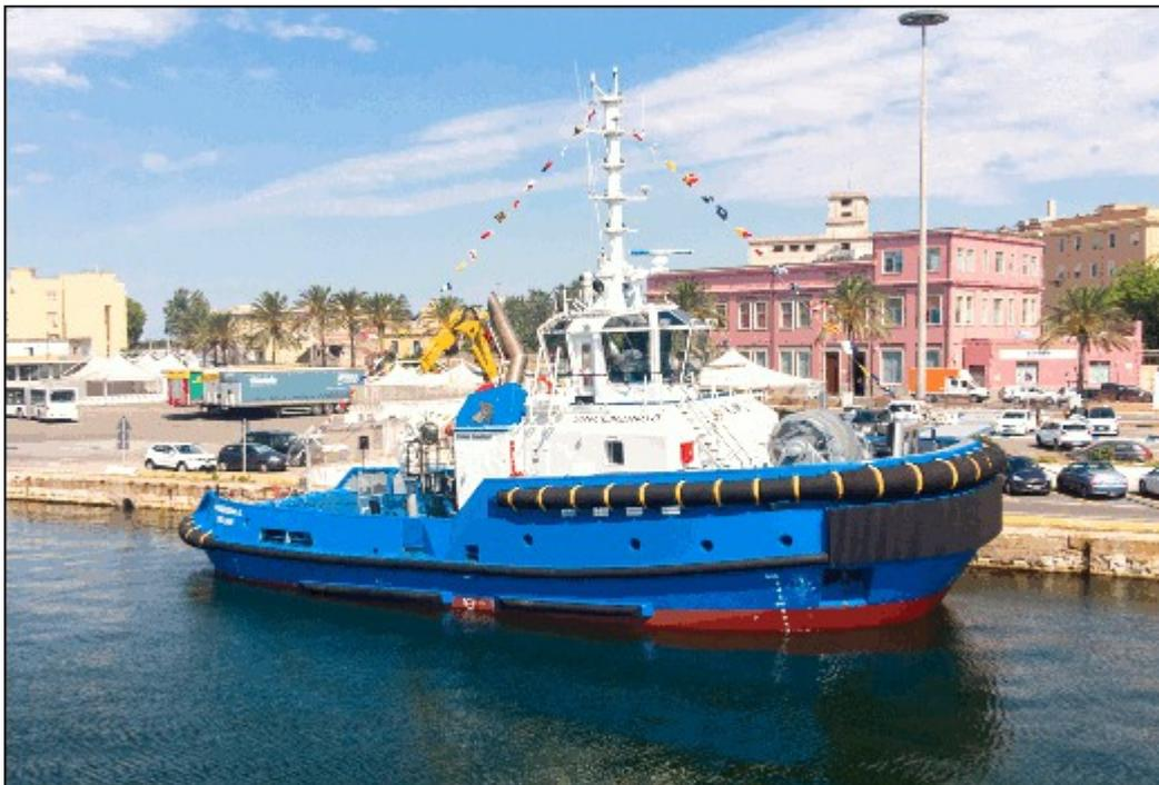
L'ASD Tug 2813, questa la sigla della serie progettata dal cantiere olandese e realizzata in Vietnam, è predisposto per l'installazione del plug & play Damen SCR NOX Reduction System, che rende questo mezzo conforme con le norme dell'IMO Tier III compliant.
