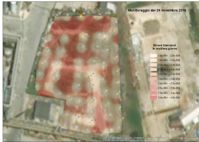
Figura 6 – Esempio di mappa di isoflussi di CO_2 e COV determinati con camera di accumulo
