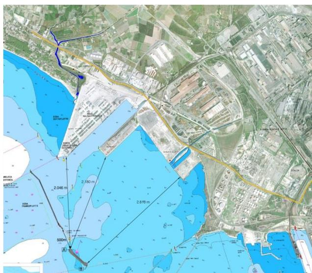
La nuova diga foranea sarà realizzata in massi naturali ed artificiali, tipologia strutturale che meglio si adatta alle caratteristiche geotecniche dei fondali.
