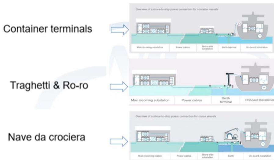
Figura 5.3. Sistemi di elettrificazione della banchina: soluzioni specifiche per tipologie di terminal e relative navi in ormeggio (Fonte: ANIE, 2019)
