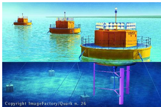
Figura 5.44: prototipo KOBOLD a turbina verticale installato nello stretto di Messina (Fonte: RSE)
