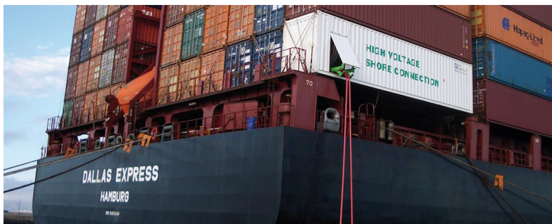
Figura 5.4: Sistema di connessione elettrica nave-banhcina Crediti: Hans Hillewaert / wikipedia.org
