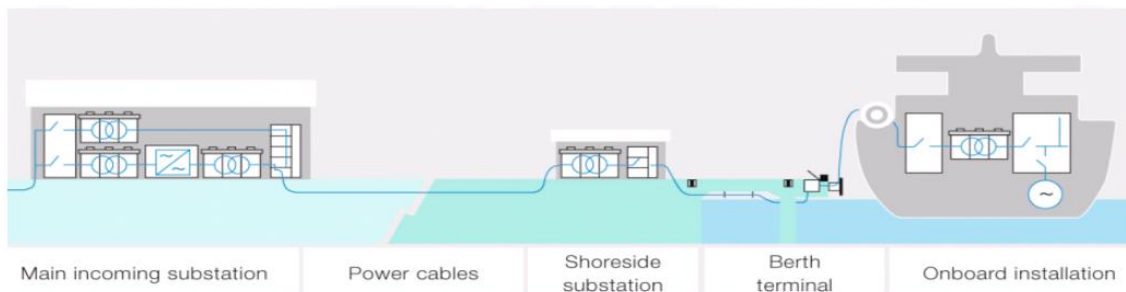
Figura 5.2. Sistema di elettrificazione delle banchine: schema tecnico base di funzionamento.
