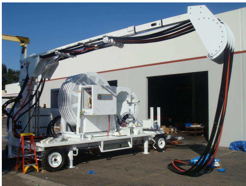
Figura 67 - Esempio di Alternative Maritime Power (AMP)
