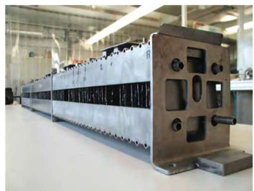
Scambiatore di calore per una unità di accumulo termico a cambio di fase, con alettature fatte con fogli di grafite, prima del caricamento del materiale a cambiamento di fase.
