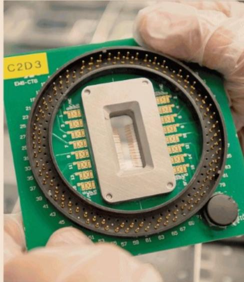
Semiconduttori. Scheda per il controllo qualità dei wafer in carburo di silicio 8In, usati negli inverter per auto elettriche
