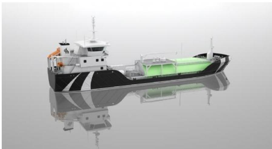
**Figura 21 - WS1 Prototipo della Whitesmoke, UK, che prevede capacità tra 700 e 1400 mc di GNL e la possibilità di effettuare in parallelo bunkering sia di GNL che di HFO**
