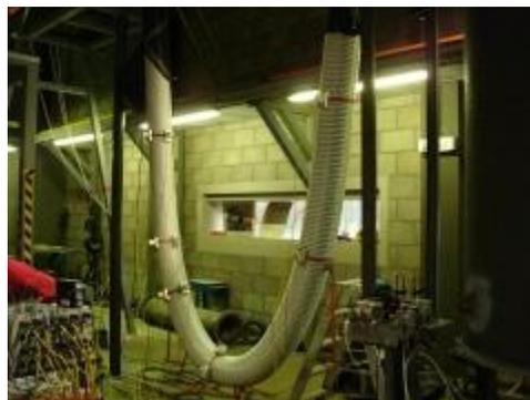
**Figura 12 - Tubazione flessibile per GNL Gutteling**
