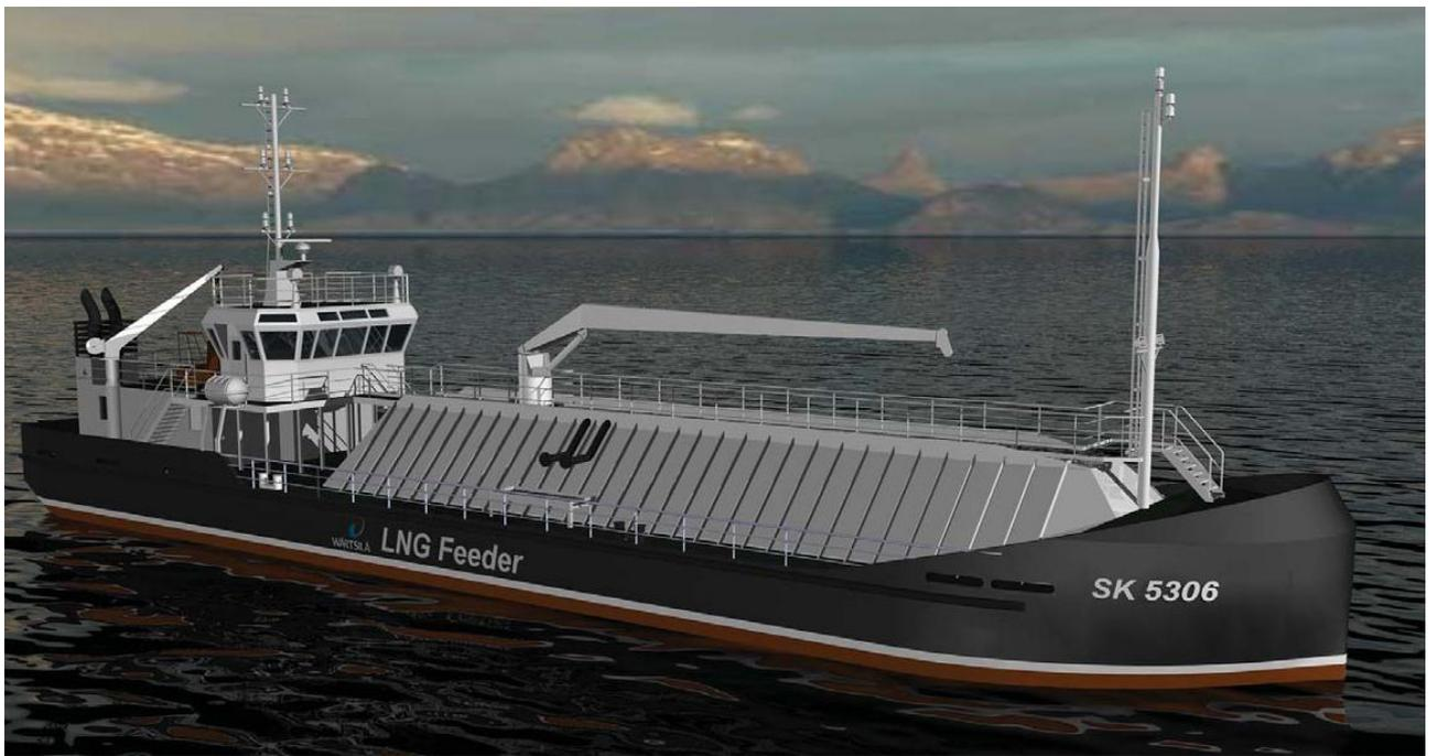
**Figura 24 - GNL bunker barge della Warstilia con stoccaggio GNL di 300 mc**
