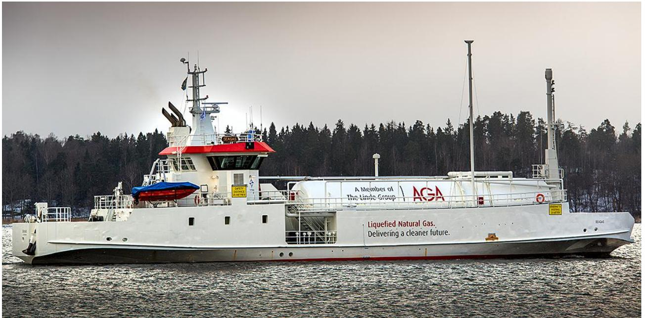
**Figura 18 - La GNL bunker vessel SEAGAS (Svezia)**
