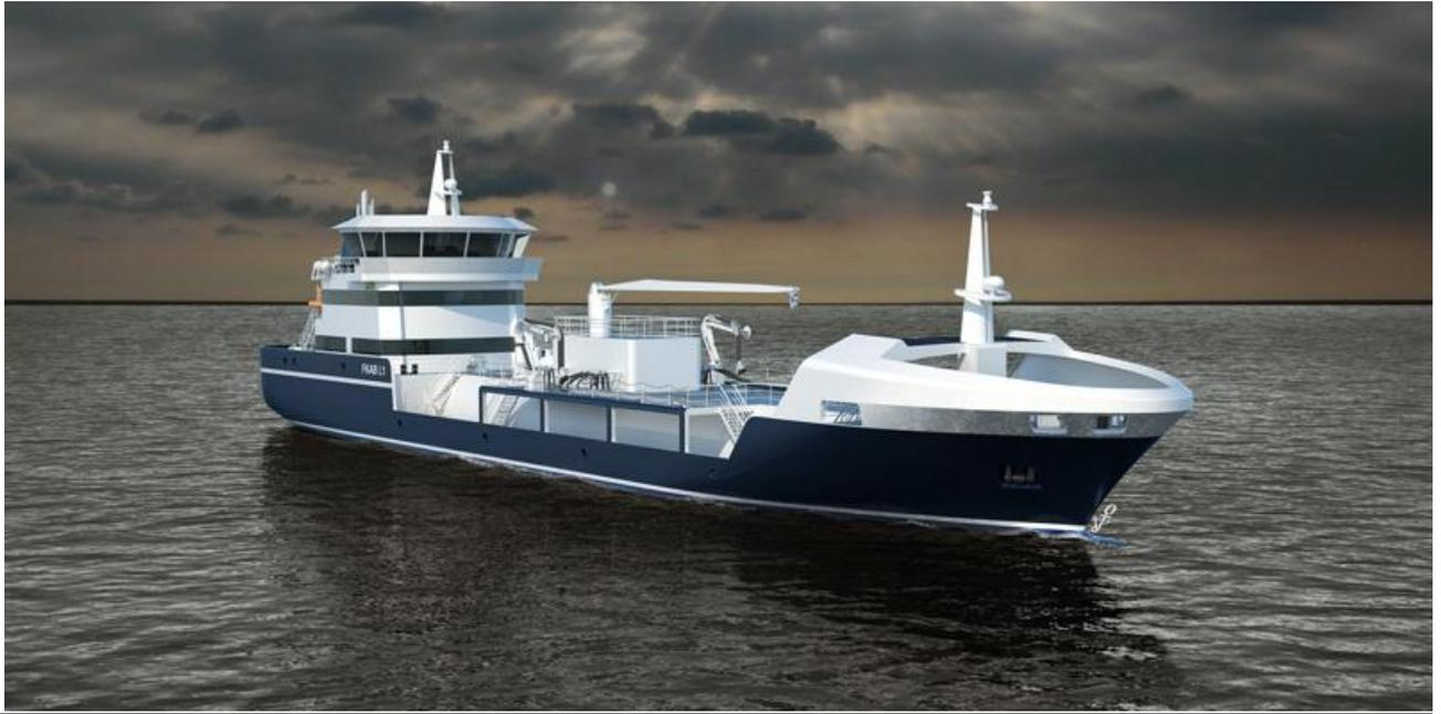
**Figura 23 - L1 della FKAB, Sweden con capacità di stoccaggio GNL 700 mc e 500 HFO**
