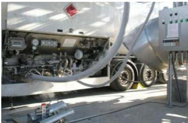
**Figura 10 - Scarico GNL mediante tubo flessibile**
