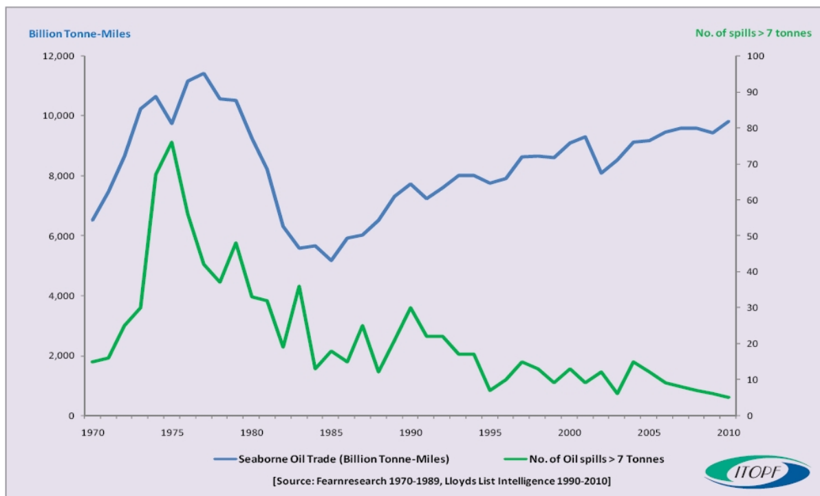
Figura 3.5: greggio sversato dal 1970 al 2010 in incidenti con sversamenti maggiori di 7 t e quantità di greggio trasportato nel mondo - Fonte: ITOPF
