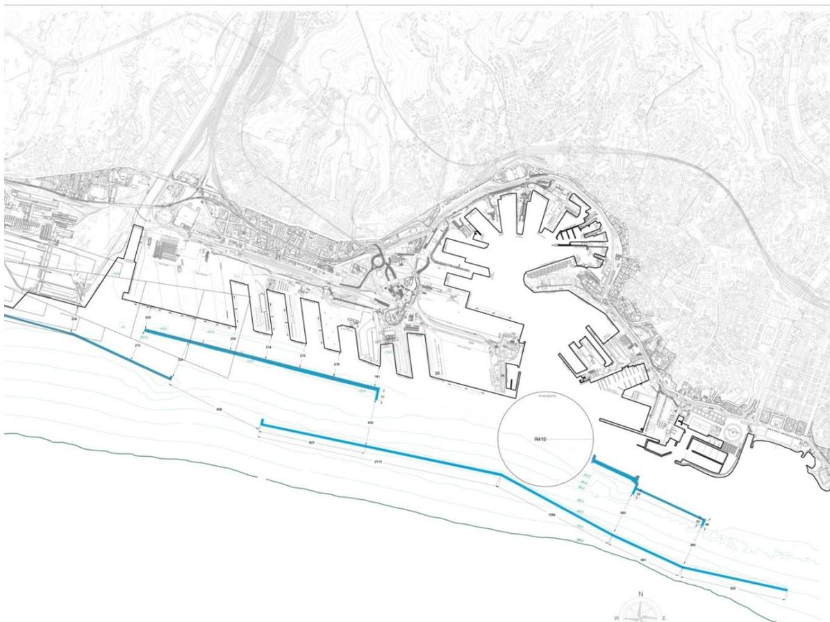
La nuova configurazione dell'Imboccatura di Levante prevede la realizzazione di una nuova opera di difesa lunga circa 4,8 km realizzata su fondali compresi tra i -30 e -45 m s.l.m.m..
