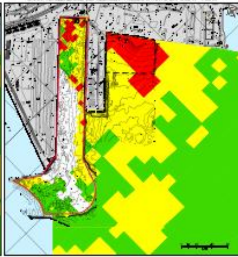
CARATTERIZZAZIONE DEI SEDIMENTI NELLO STRATO DA -2.00 A - 2.50 m
