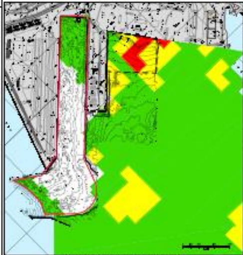
CARATTERIZZAZIONE DEI SEDIMENTI NELLO STRATO DA -1.50 A - 2.00 m
