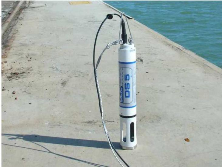
La quantità di materiale in sospensione in ogni punto è calcolata dal valore medio della torbidità lungo la colonna d'acqua con correlazione NTU-mg/l definita da CORILA nell'ambito di alcuni studi condotti in aree prossime ai cantieri dei lavori per la costruzione delle opere alle bocche lagunari
