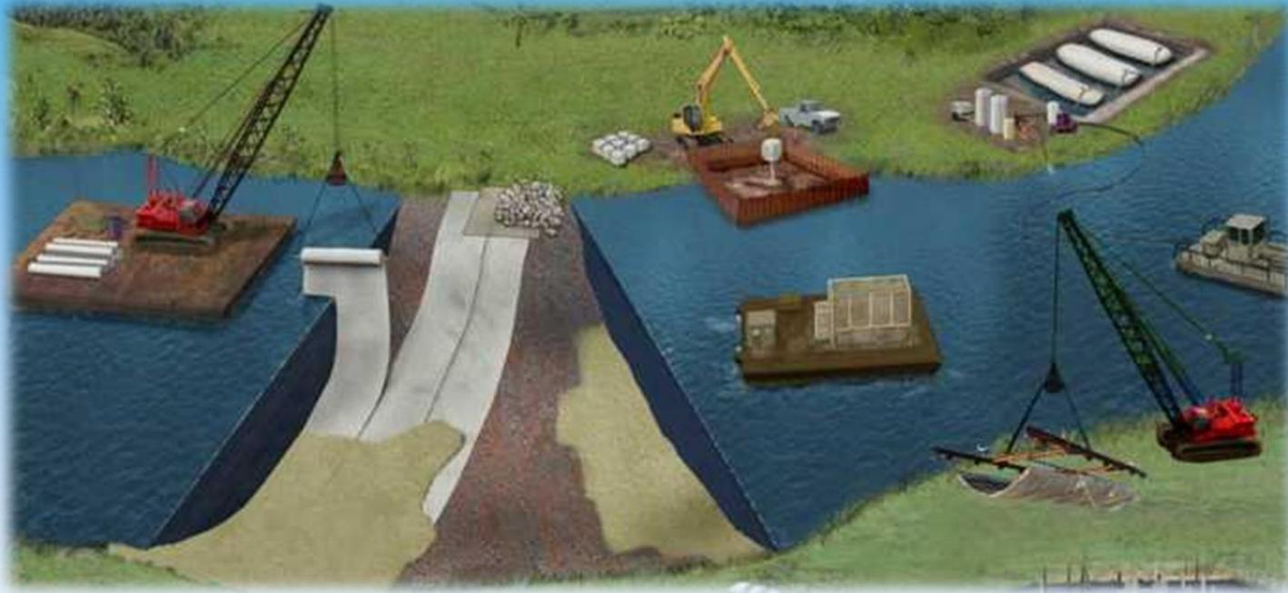
**Posa in opera della membrana in HDPE in acqua**
