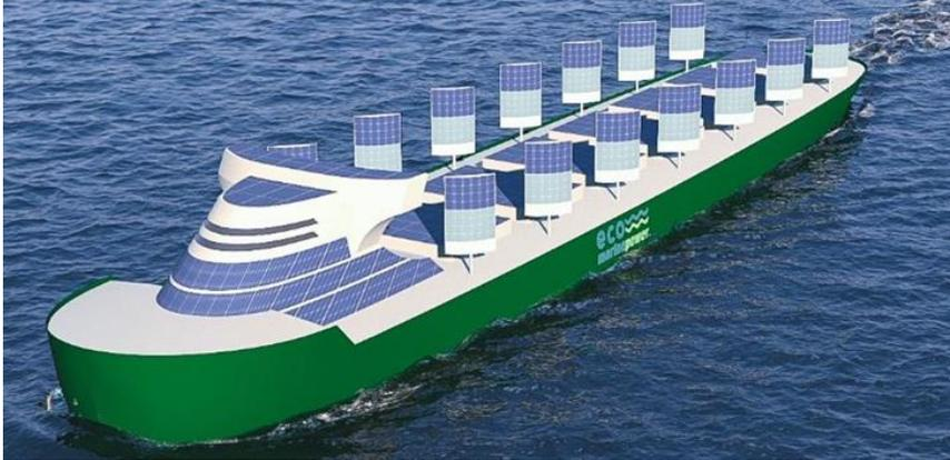
essere dotata di altri strumenti per il risparmio di carburante come un avanzato sistema di propulsione elettrica, un impianto di illuminazione LED a bassa energia, la lubrificazione dell'aria, una progettazione ottimizzata dello scafo e
