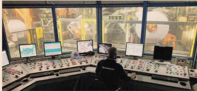
Siderurgia. La centrale di controllo per lo spostamento e la lavorazione delle bobine di acciaio del gruppo Marcegaglia
