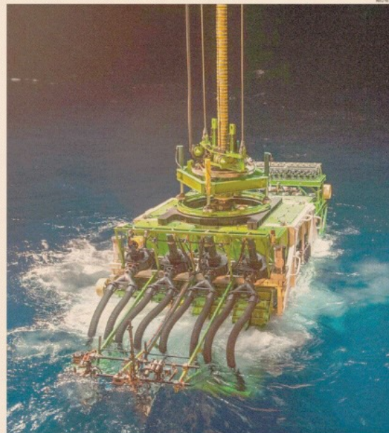
A caccia di metalli in fondo al Pacifico. Un robot per l'estrazione di manganese, nickel, cobalto e rame sui fondali marini.
