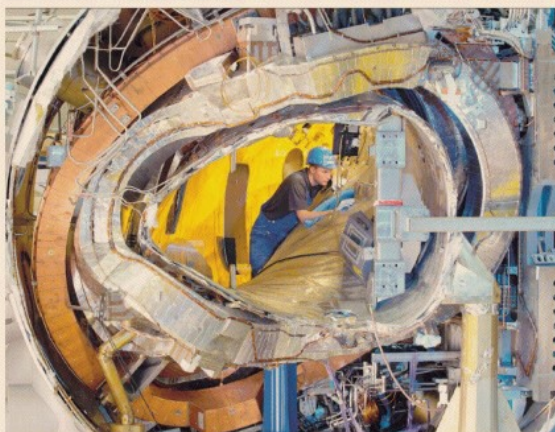
Made in Italy. Un magnete Agg per il reattore a fusione Stellarator Wendelstein W7-X
