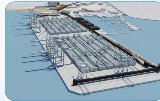
La piattaforma multifunzionale presenta una superficie complessiva di circa 211.000 m<sup>2</sup> ed è composta di una zona rettangolare lato mare con dimensioni di 290 m x 700 m e di una zona di radicamento a terra di forma quasi trapezoidale, con dimensione minima lato terra di circa 95 m.
