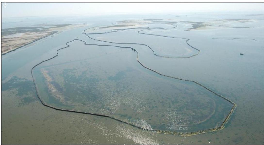
Figura 2. Refluitamento diretto del sedimento proveniente dalla draga (Barena Palude Burano Sud).
