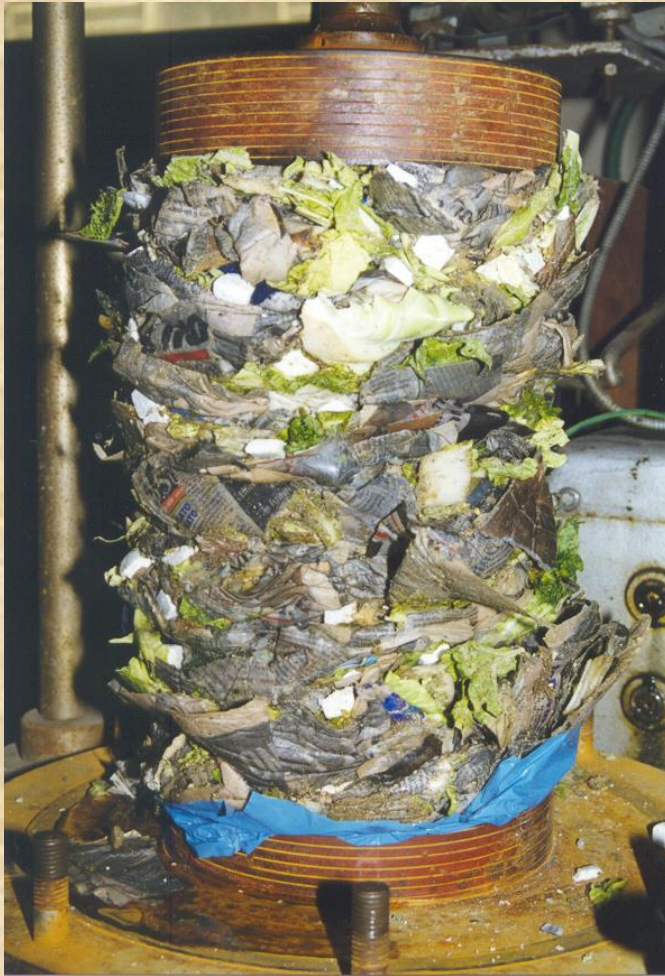
Prova ELL senza membrana
