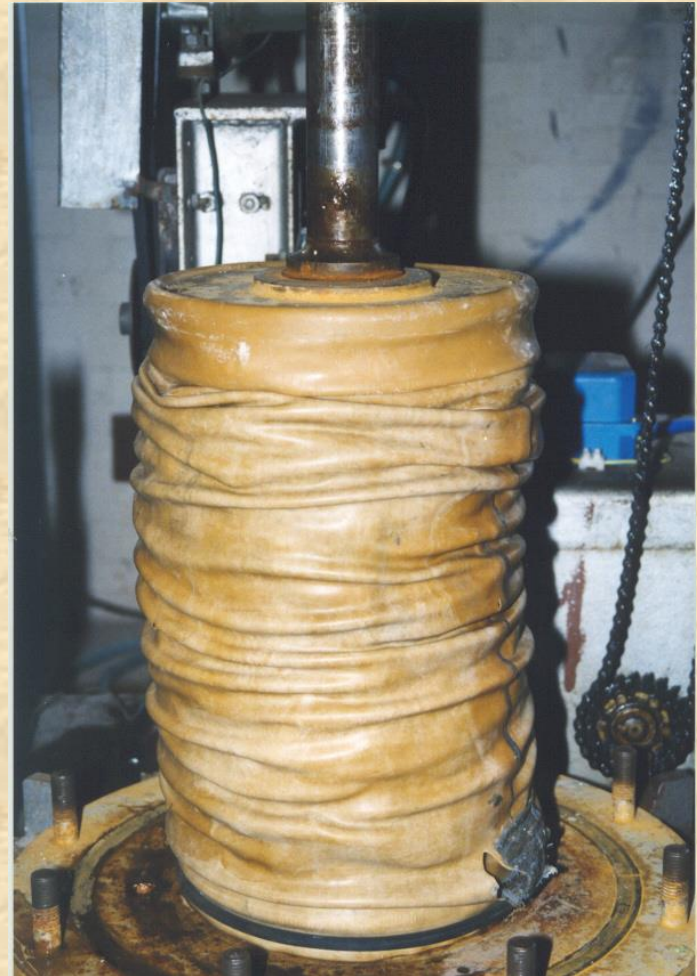
Prova ELL con membrana
