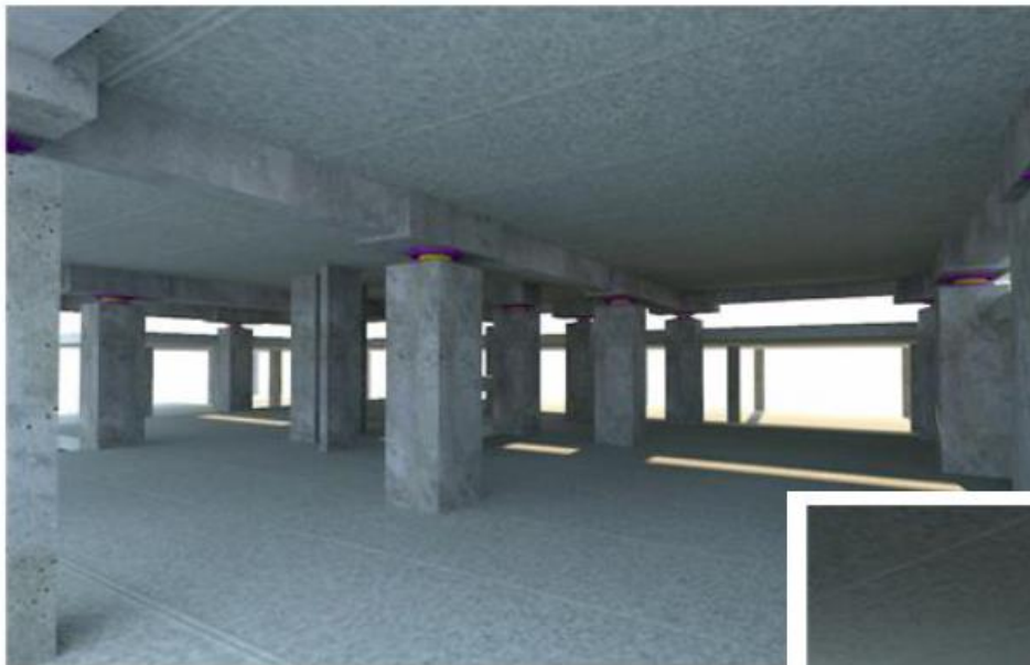
Figura 42: Vista 3D isolatori piano interrato
