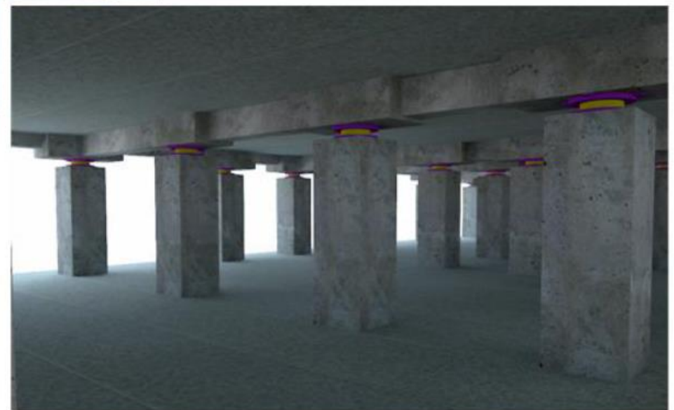
Figura 43: Vista 3D isolatori piano interrato/2
