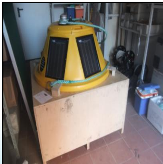
Boa di back-up Fugro SEAWATCH Minill
