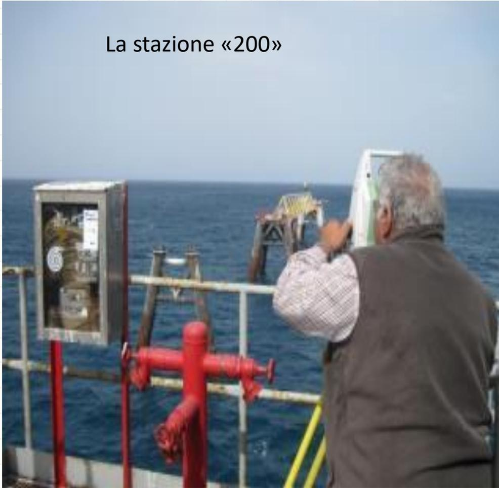
Al fine di tenere in considerazione i movimenti delle strutture metalliche a seguito del modo ondoso, su ognuna delle flange rilevate sono state eseguite una serie di misure intervallate di pochi secondi l'una dall'altra (vedi tabella).
