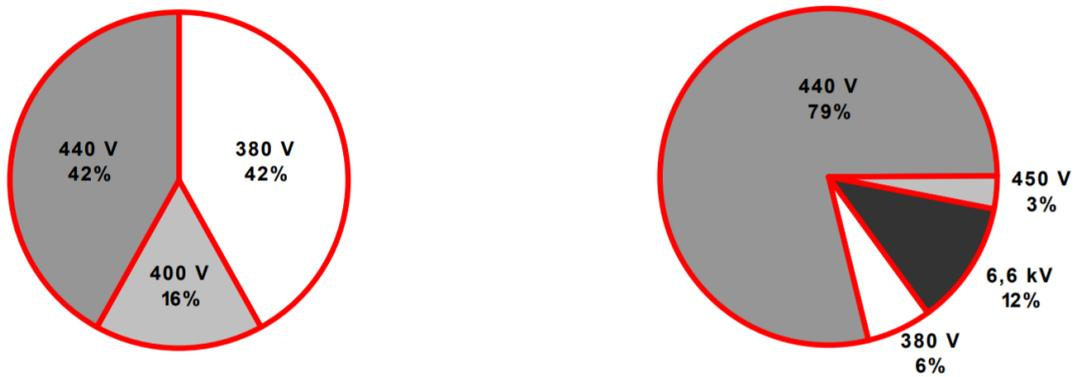
Figura 10 - Sistema di voltaggio utilizzato per navi feeder-sea (a Sinistra) e deep-sea (a Destra) (fonte: Ericsson, 2008)
