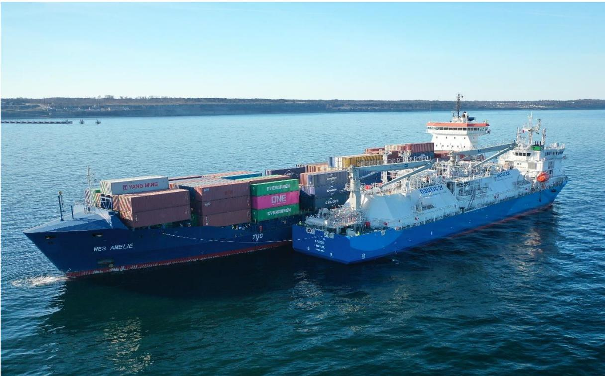
Figura 38 - Ship-to-Ship Operazione di trasferimento di GNL in mare (fonte: [www.unifeeder.com](http://www.unifeeder.com))
