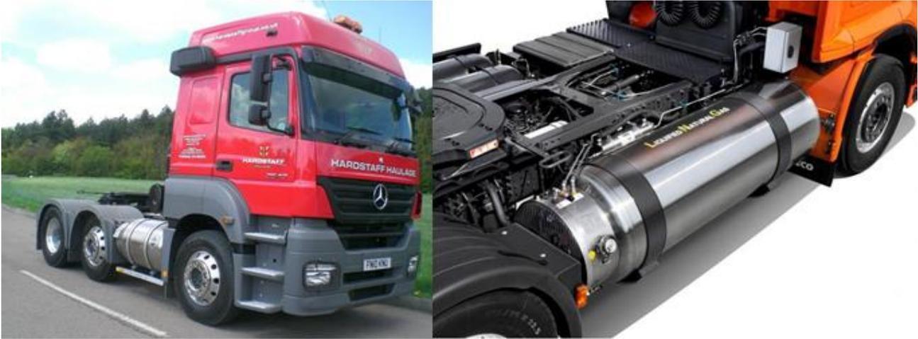
Figura 33 - Hardstaff Mercedes Benz Actros-Tecnologia a due carburanti (Sinistra) e Serbatoio di GNL (Destra). (fonte: Ingbc.eu)
