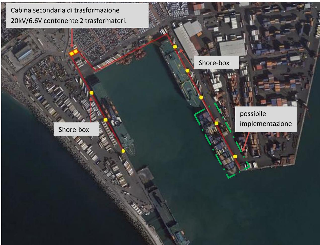
Figura 27 - Lay-out della rete in MT
