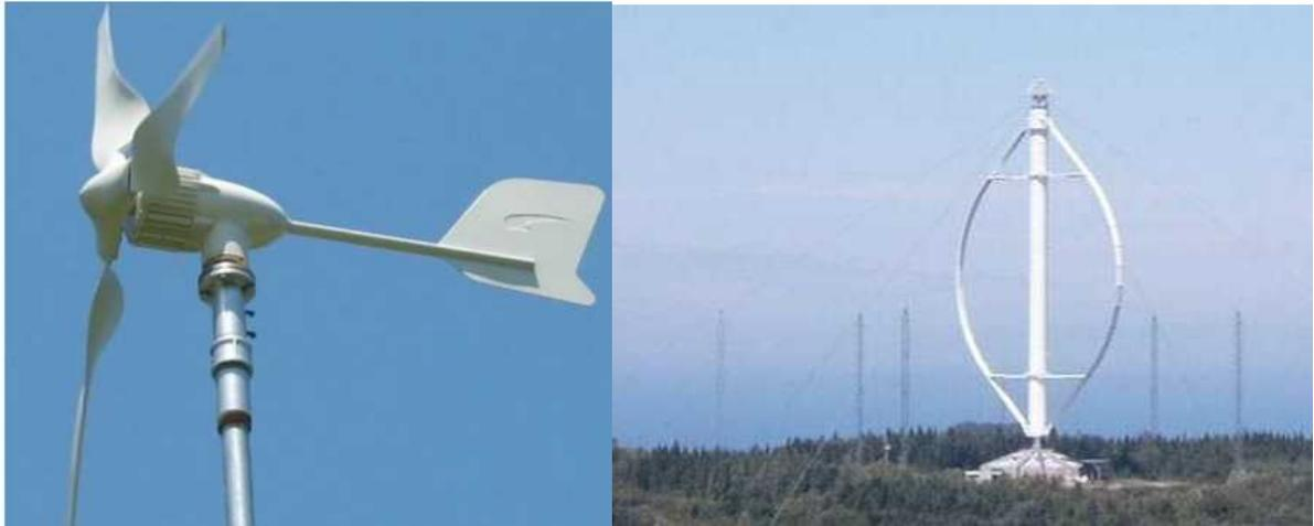
Figura 39. Esempi di microturbine eoliche ad asse orizzontale e verticale
