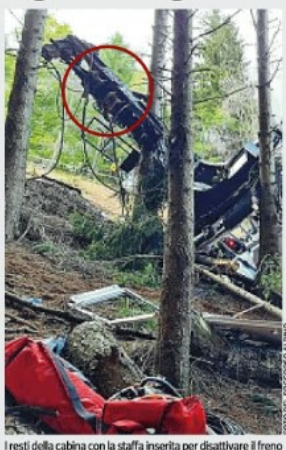
Resti della cabina con la staffa inserita per disattivare il freno
