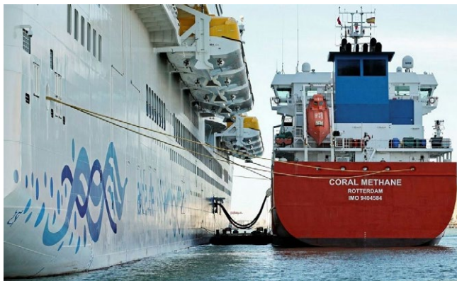
Nave cisterna in fase di rifornimento di LNG a una nave AIDA.
