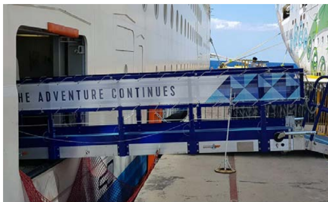
Boccaporto a quota banchina con accesso attraverso passerella.
