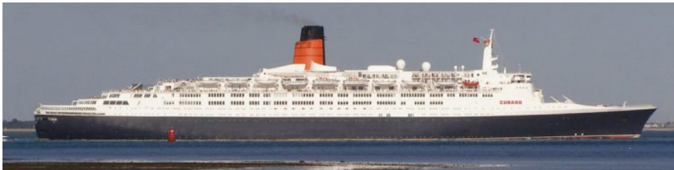
Queen Elizabeth 2 nelle acque di Southampton con il nuovo fumaio massivo per i motori diesel, post 1987.
